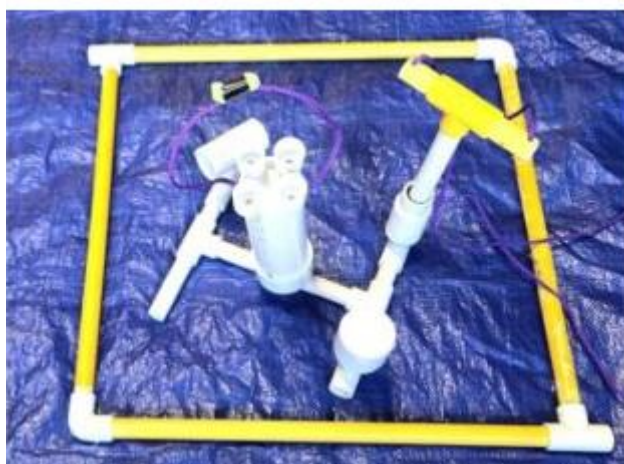
Разъем установлен в датчик эДНК
